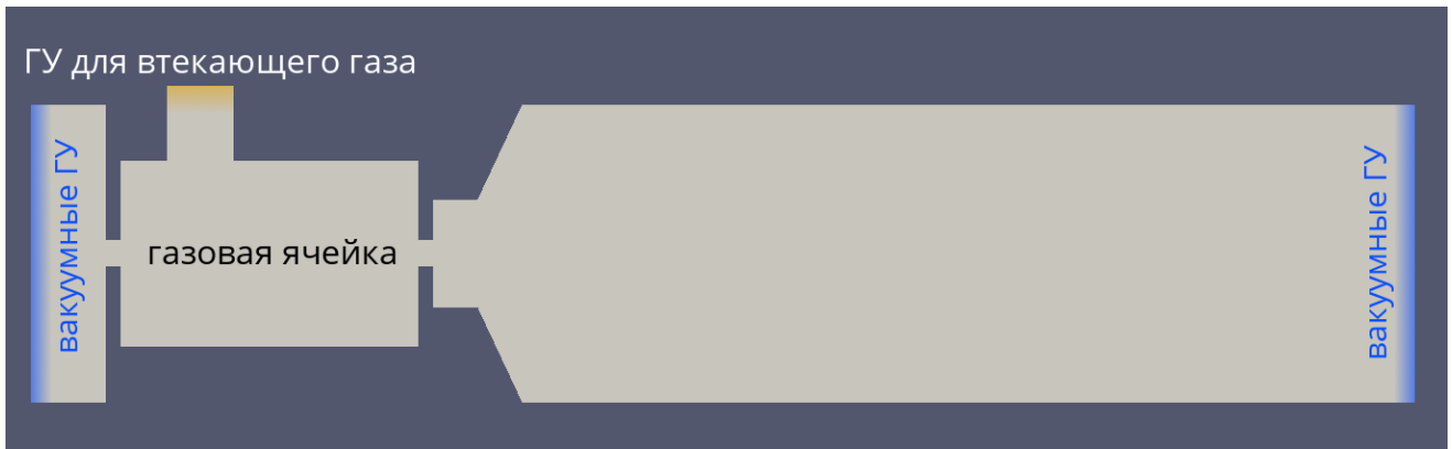
Рис. 45: Двумерная модель газовой ячейки. Затененные участки показывают границы со специальными граничными условиями (ГУ) для подводящей трубки и вакуума снаружи ячейки. Прочие границы имеют стеночные граничные условия.
