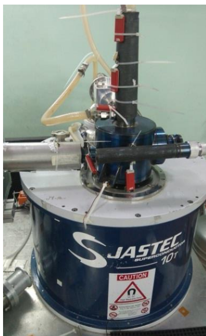
Рисунок 2. Фотография гиротрона, установленного в криомагнит.
