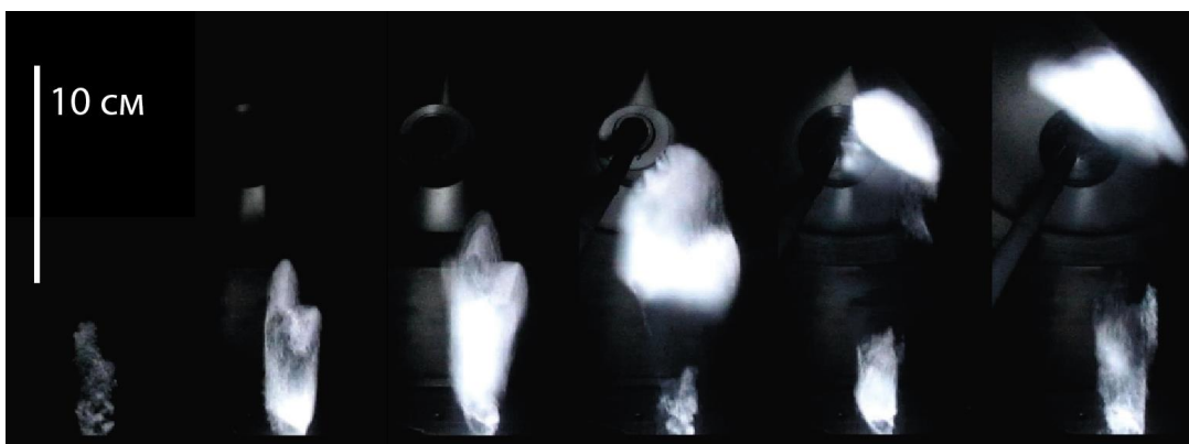
Рисунок 89. Набор фотографий разряда с длительностью выдержки 33 мс в криптоне, давление 1.1 атм, мощность греющего излучения 1 кВт, частота 0.263 ТГц.
