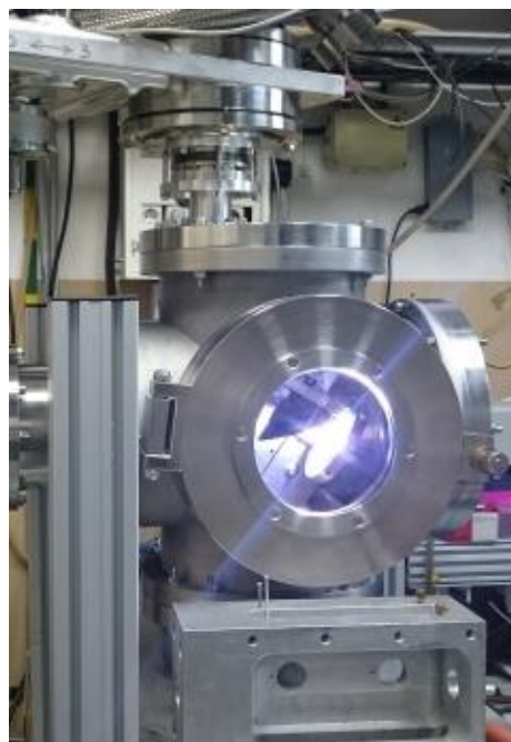
Рисунок 21. Фотография экспериментального стенда на новосибирском ЛСЭ. Так же на фото можно увидеть свечение разряда в области перетяжки пучка.
