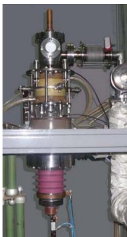
Рисунок 44. Фотография гиротрона генерирующий излучение частотой 1ТГц
