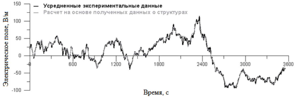
Рисунок 1.9 – Вертикальное электрическое поле E_z(t) : экспериментальное (черная линия) и модельное (серая линия), построенное на основе данных для первых 100 структур, полученных при последовательных итерациях
